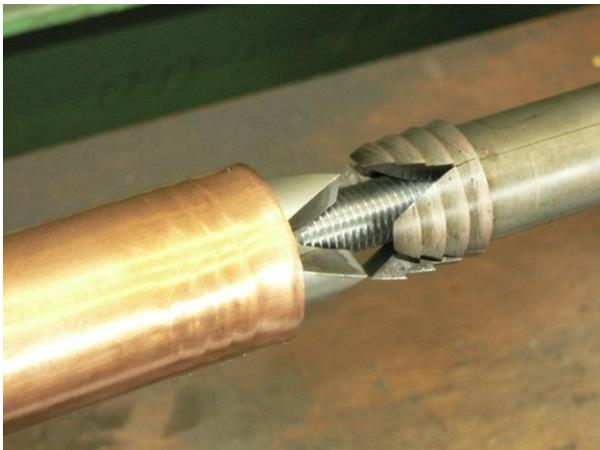
Abb. 2-2: Innenspannwerkzeug
