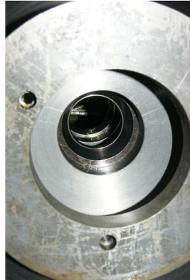
**Abb. 2-4:** Verstellbare Vorrichtung zum Ziehen mit definiertem Versatz und doppelt ausgelegtem Werkzeug. Links: Führungsmatrize, rechts: Ansicht auslaufseitig
