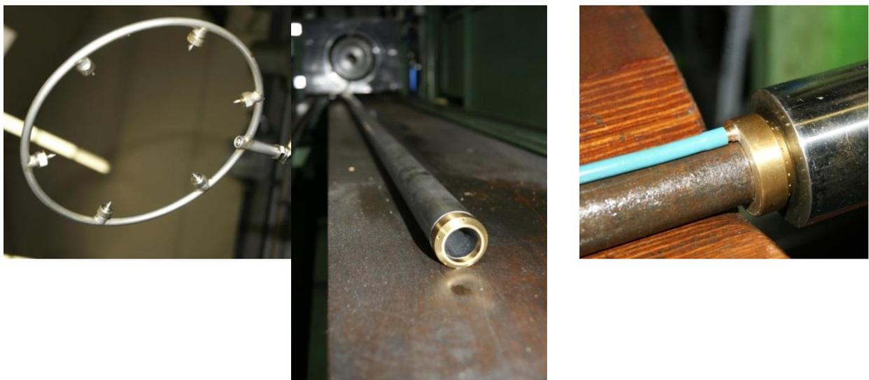
**Abb. 2-1:** Düsenanordnungen für die Schmierung der Rohre für die Außen- (links) und Innenfläche. Innendüse zur Abdeckung eines weiten Bereiches an Innendurchmessern (v. l. n. r.)
